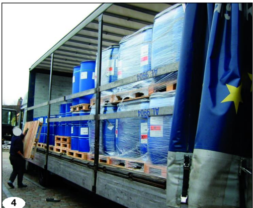
4 Der Fahrer baut eine künstliche Stirnwand aus Paletten, damit die obere Lage nicht verrutschen kann...
