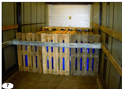
7 So soll es sein: Dank guter Ladungssicherung wurden diese Fässer bei einem Crash – Aufprall mit 60 Stundenkilometern – nicht beschädigt.
