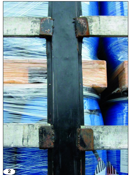
2 ... wer genauer hinschaut, erkennt die unprofessionelle Schweißarbeit. Dieser Transport muss stehenbleiben,...
