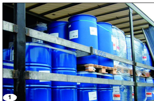
1 Solide gesichert? Bei flüchtiger Betrachtung sieht diese formschlüssige Ladungssicherung ganz ordentlich aus. Doch ...
