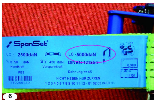
6 Auf dem Zurrgurt wird der einfache (links) und der doppelte LC-Wert (rechts im roten Kreis) angegeben.
