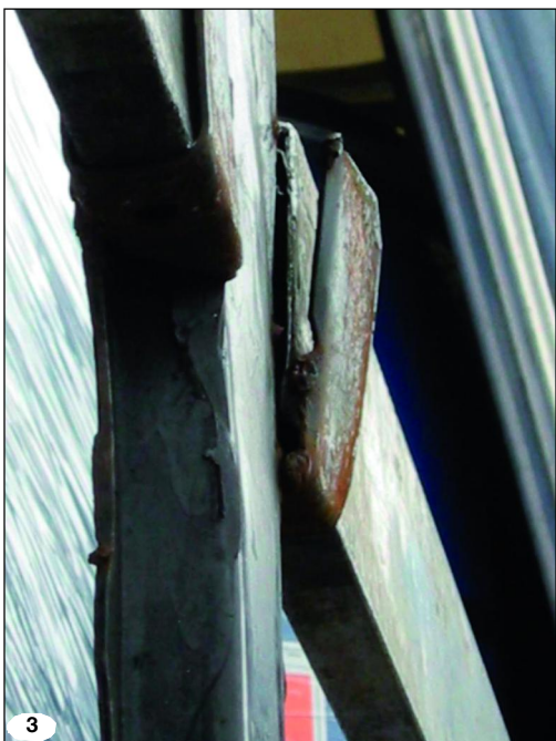
3 ... bis die Fässer zusätzlich gesichert werden. Denn diese Aufbauten können die Ladung während des Transportes nicht sicher halten.
