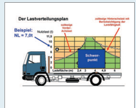
Abb. 2.: Die Ladung muss im Bereich von 2,4 m bis 4,9 m liegen, um die zulässigen Achslasten nicht zu überschreiten.
