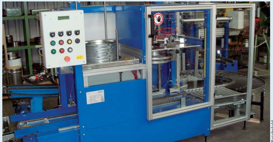
TAC-System von Reichsfeld: Deckel auf die Fässer, Verschließen, Sichern — vollautomatisch.
