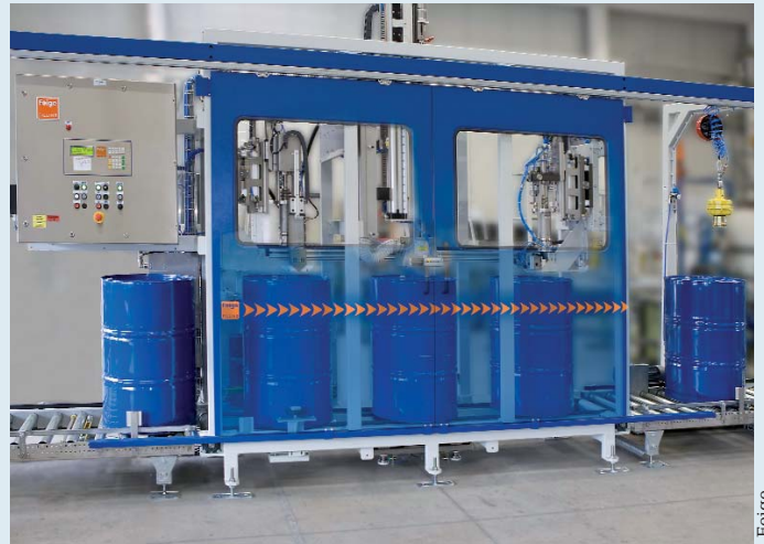
Filling Fassfüllanlage vom Typ 33, auch für den Einsatz in explosionsgefährdeten Bereichen ausrüstbar.
